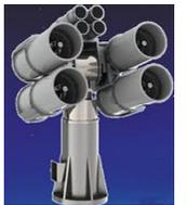
高感度・低損失のアレイ型光受信アンテナ
