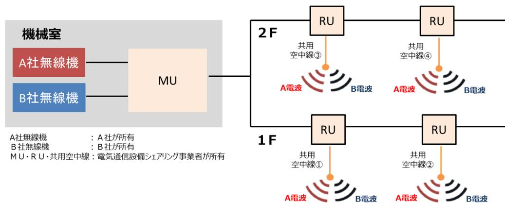
他方、各移動通信事業者の希望する電波発射の具体的な場所が全て一致しているとは限らず、図2のように、電波発射の具体的な場所の希望が一致する箇所（共用空中線 i・iii）と一致しない箇所（共用空中線 ii・iv）が混在する場合もある。この場合、A社については、共用空中線 i～ivに係る無線局の免許が必要となるが、B社については、B社と電気通信設備シェアリング事業者との間で、電波の発射を行う意思がない共用空中線 ii・ivについて、
