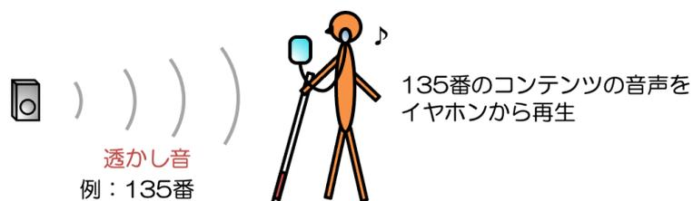
また、貸出時の動作は次のようなフローとなっている。端末の電源を入れるとアプリが自動的に起動して、Wi-Fi経由で専用端末管理サーバーにアクセスし、自身の貸出状況を取得し、貸出状態の場合はコンテンツ管理リストのjsonをダウンロードし、jsonにある情報にしたがってコンテンツをダウンロードし、準備状態となる。コンテンツのダウンロード中あるいは、ダウンロード完了のステータスとは端末管理サーバーに登録されて管理され、その情報は管理タブレットに表示される。貸出担当者はダウンロードが完了したら、お客さんに端末を貸し出す。利用が終了して端末が返却されたら、返却処理を管理タブレットから行うと音声ガイド端末は貸出待ち状態になる。貸出待ち状態は、音響透かしをマイクから受信しない状態である。
