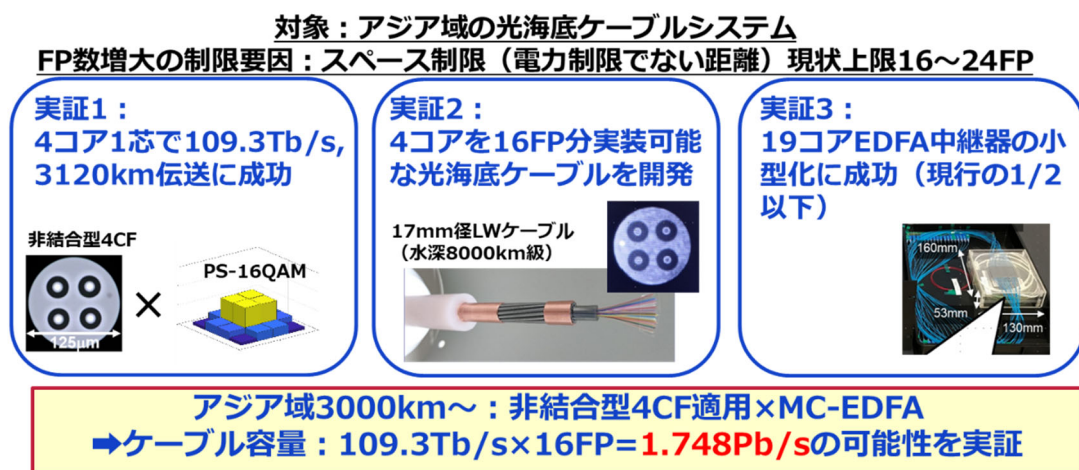
図 3.1.1.2 マルチコアファイバを用いた光海底ケーブルシステム骨子
