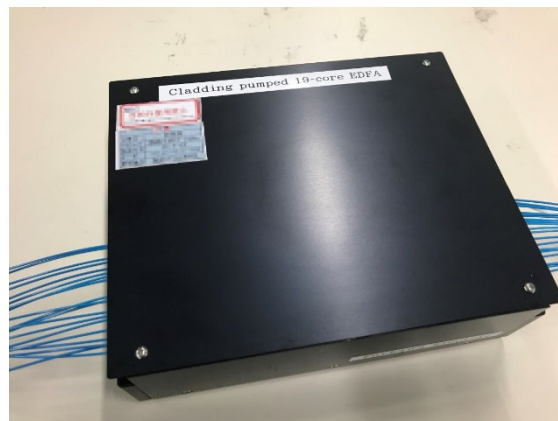
図 3.2.2.2 試作したマルチコアゲインブロック
