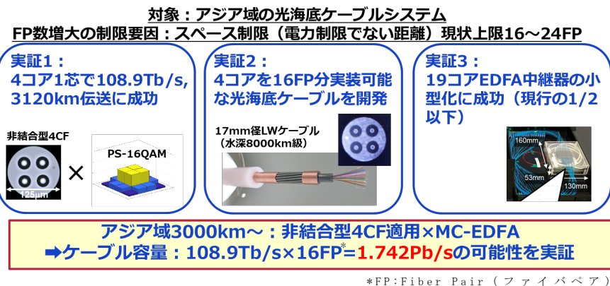
図ア a マルチコアファイバを用いた光海底ケーブルシステム骨子
