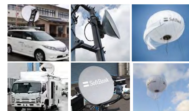
可搬型基地局・衛星アンテナ 気球中継基地局
