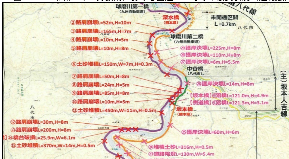
図 7 令和 2 年 7 月豪雨における国道 219 号等の被災状況（速報版）
