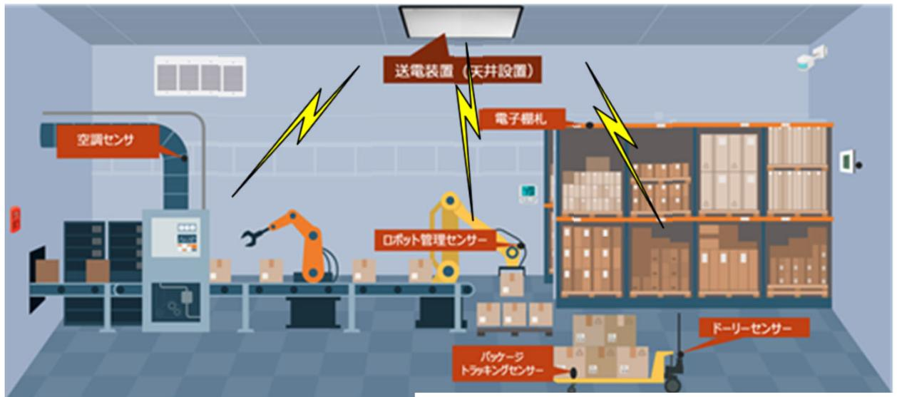
＜工作機械の可動部のセンサー（断線しやすい）への給電によるメンテナンスフリー化＞
