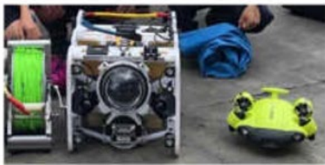
〈R3年に度海洋科学高校で扱った水中ドローン〉 左：fulldepth社 産業用水中ドローン（国産） 右：QYSEA社 汎用水中ドローン（中国製）
