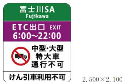
図 4-109 休憩施設接続型スマートインターチェンジ車種時間制限看板（休憩施設内に設置するもの）
