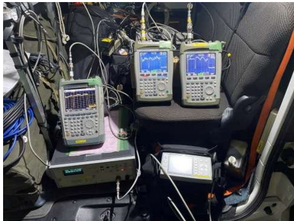
各アンテナから接続した3台のスペアナ
