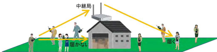
図4 自動的に又は遠隔操作によって動作するデジタル簡易無線の例（構造物による遮蔽がある場合等）
