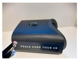
外装はプラスチック製のカバーで囲い、 接触や落下に耐えうる耐久性を確保
