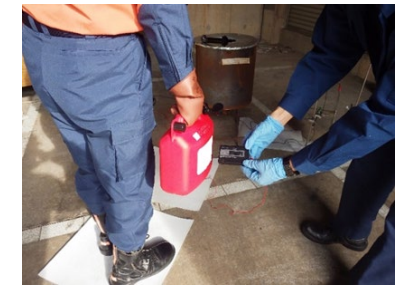
揺動後の運搬容器の 表面電位計測状況
