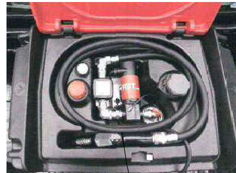
給油機器と一体となった構造の運搬容器
