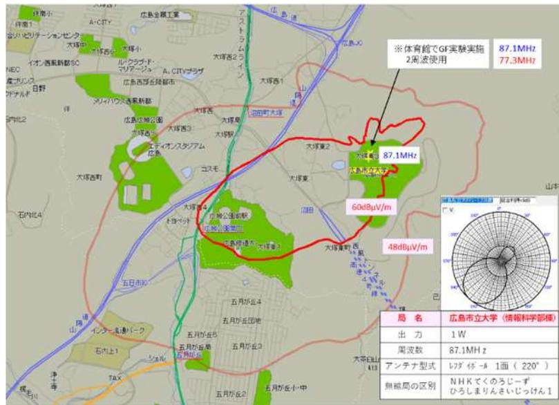
実験用(FM受信)アンテナ設置 イメージ
