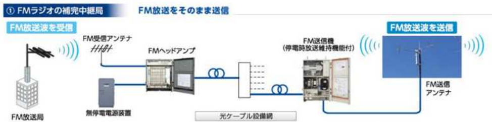
図 3-8 ギャップファイラー装置のシステム基本構成
