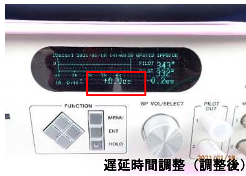
図 4-18 SFN アナライザーによる遅延調整状況
