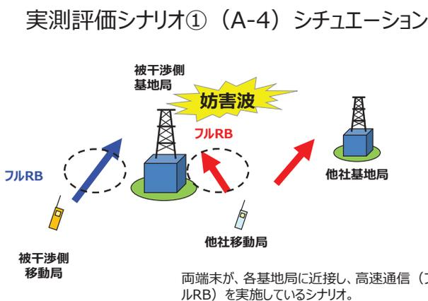
電力比を固定(3GPP ACS※1の43.5dB等※2)して、同時にレベルを上げていく
