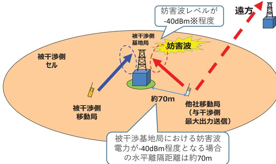
※ 基地局高：40m、移動局高：1.5m、移動局最大電力：23dBm、周波数：835MHz、伝搬モデル：拡張秦Urbanモデル、基地局アンテナ利得：17dBiより算出
