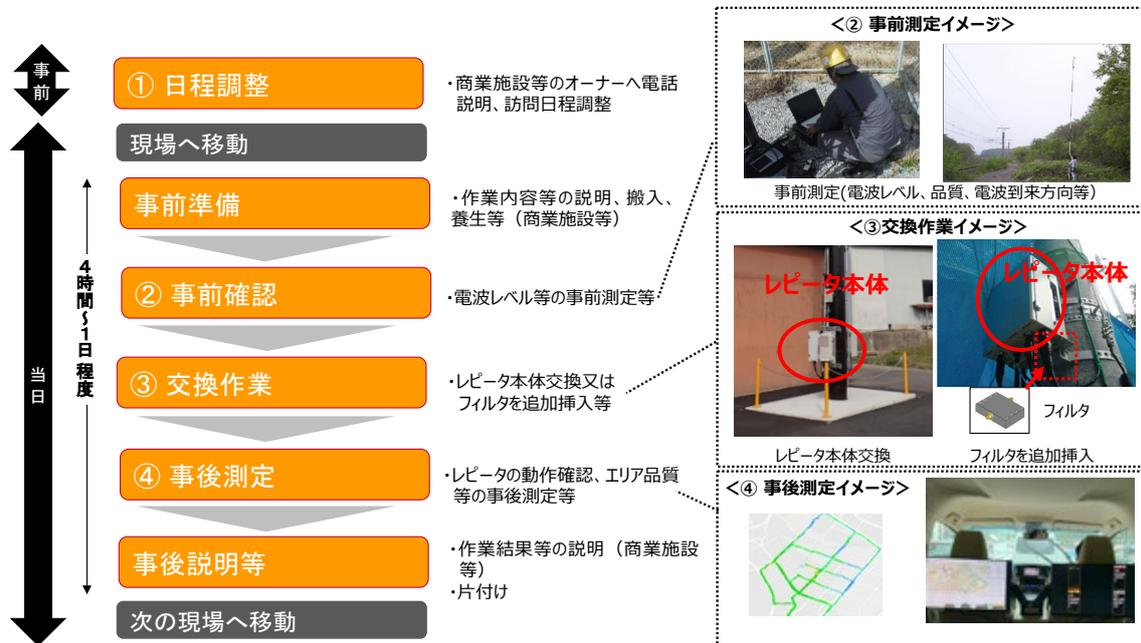
図表 20: 高出力レピータの作業工程
