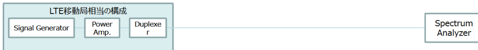
図1：過去の情報通信審議会における共用検討時の実験系 (LTE端末実機が存在しなかったため、LTE端末相当のデバイスを用いて、有線接続して測定)
