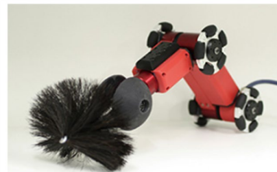
立命館大学との共同開発 カシオペア型ダクト清掃ロボット
