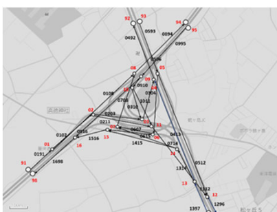
道路特定情報として道路リンクIDを用いた場合の模式図(鶴島ジャンクションの例)
