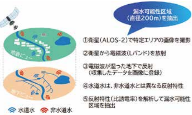
衛星から地中に届くレーダーを照射し、水道水と非水道水（比誘電率の低さ）から漏水の有無を判別する。
