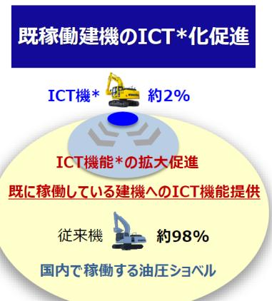
\*ICT化、ICT機およびICT機能とは、国土交通省が推進する「i-Construction」のICT活用工事でICT建機として定義されている、3Dマシンガイダンス(3D-MG)および、3Dマシンコントロール(3D-MC)機能搭載した建機、機能となります。
