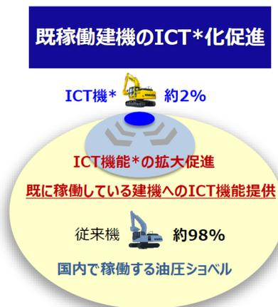
\*ICT化、ICT機およびICT機能とは、国土省が推進する「i-Construction」のICT活用工事でICT建機として定義されている、3Dマシンガイダンス(3D-MG)および、3Dマシンコントロール(3D-MC)機能搭載した建機、機能となります。
