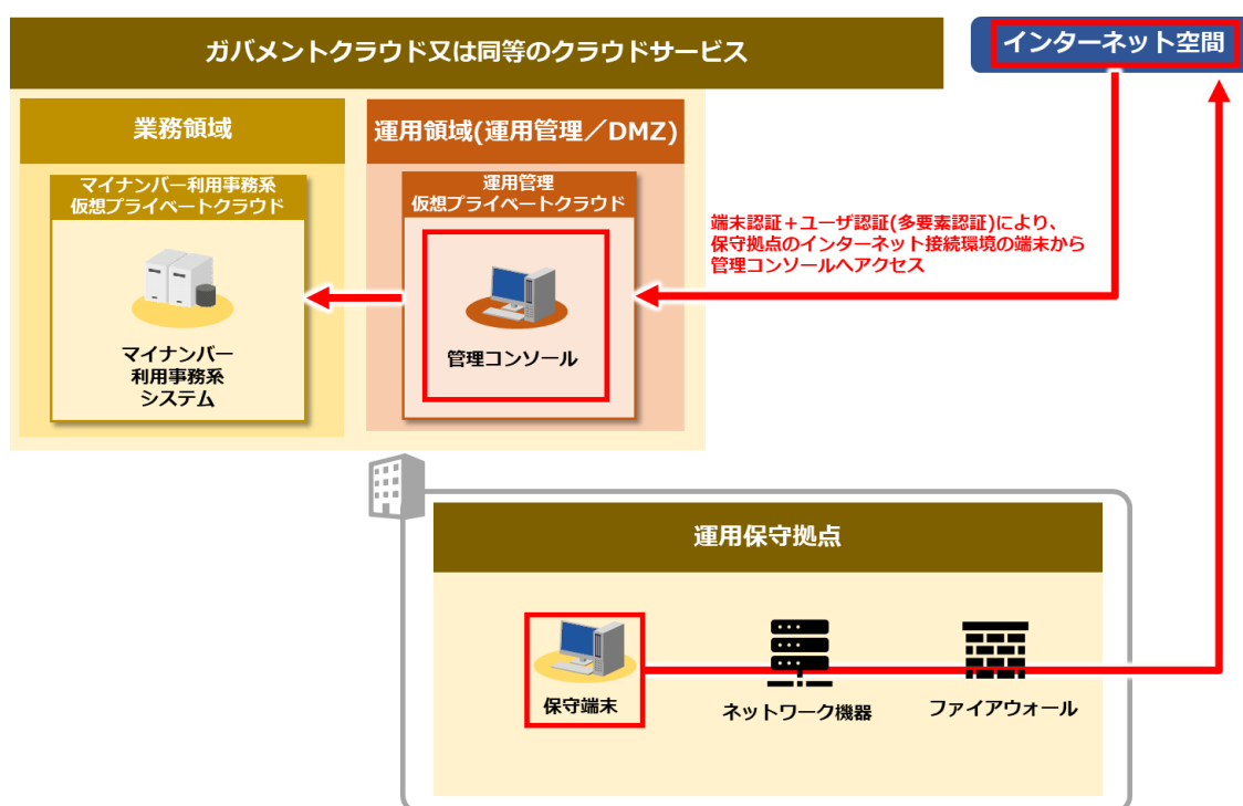
図表 38 インターネット経由での標準標準システム等の運用保守(管理コンソール接続)を実施する場合の接続イメージ
