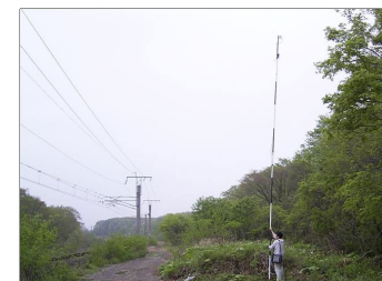
事前測定(電波レベル、品質、電波到来方向等)
