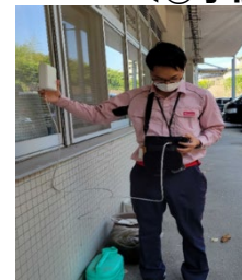
事前測定(電波レベル、品質、電波到来方向等)
