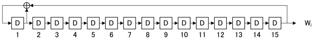
図 3.2.1.6.3.3-2 キャリア PRBS 生成回路
