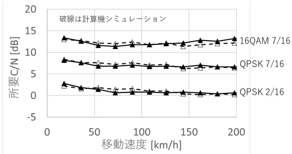
図 2-6 室内実験における速度耐性の結果
