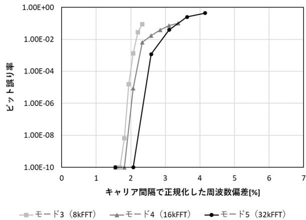
図 3-6 キャリア間隔で正規化した周波数偏差に対する BER 特性
