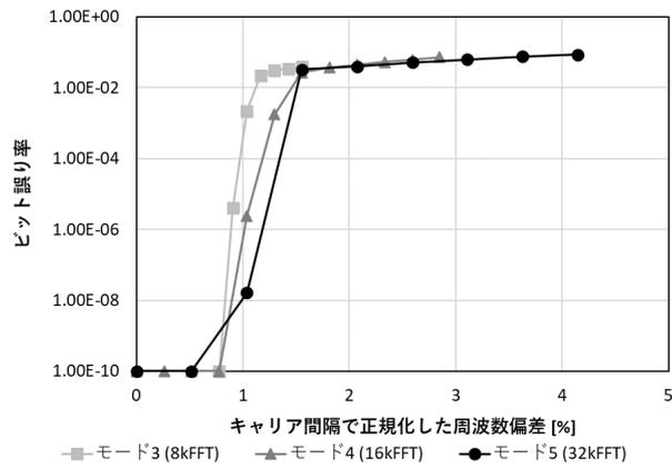
図 3-11 キャリア間隔で正規化した周波数偏差に対する BER 特性
