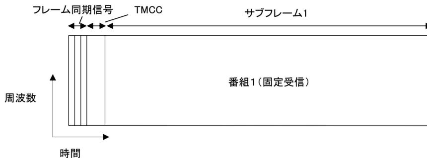
図 4.1-1 固定受信向けの構成例
