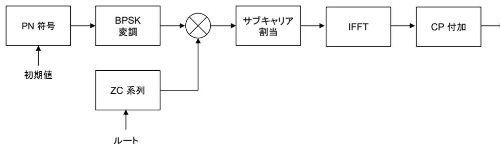
図 3.2.1.4.1.1 フレーム同期信号生成部の構成
