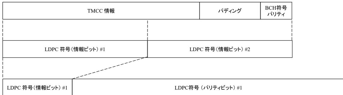
図 3.2.1.5.2-1 伝送制御情報の誤り訂正符号化
