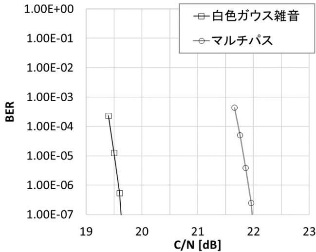
図 3-1 計算機シミュレーションにおける C/N に対する BER 特性
