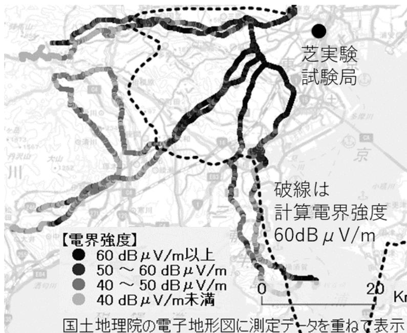
図 6-7 測定ルート上の電界強度
