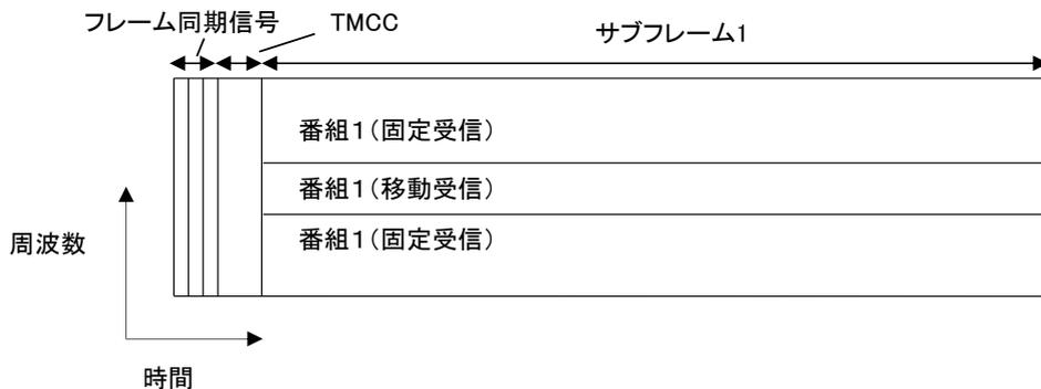
図 4.1-2 固定受信向けと移動受信向けの構成例 1
