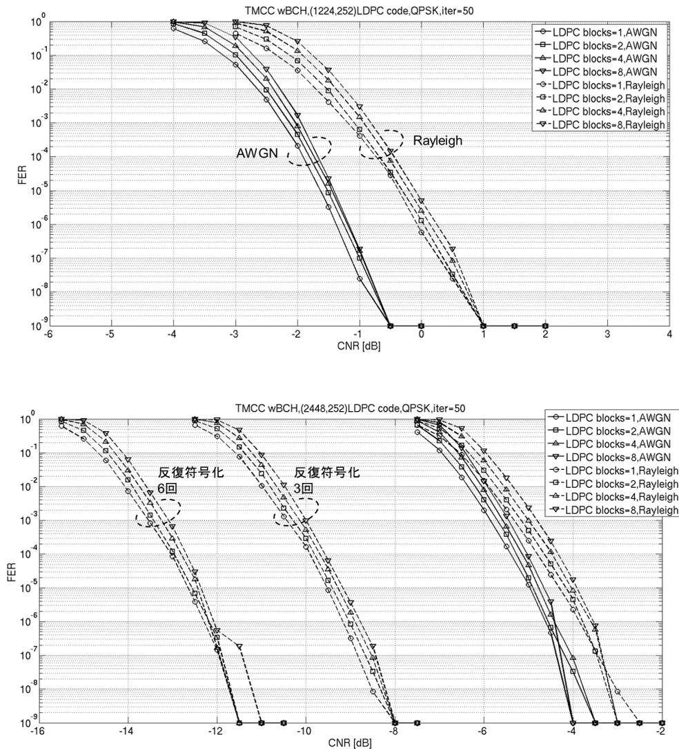
図 2-1 TMCC 誤り訂正符号シミュレーション結果
