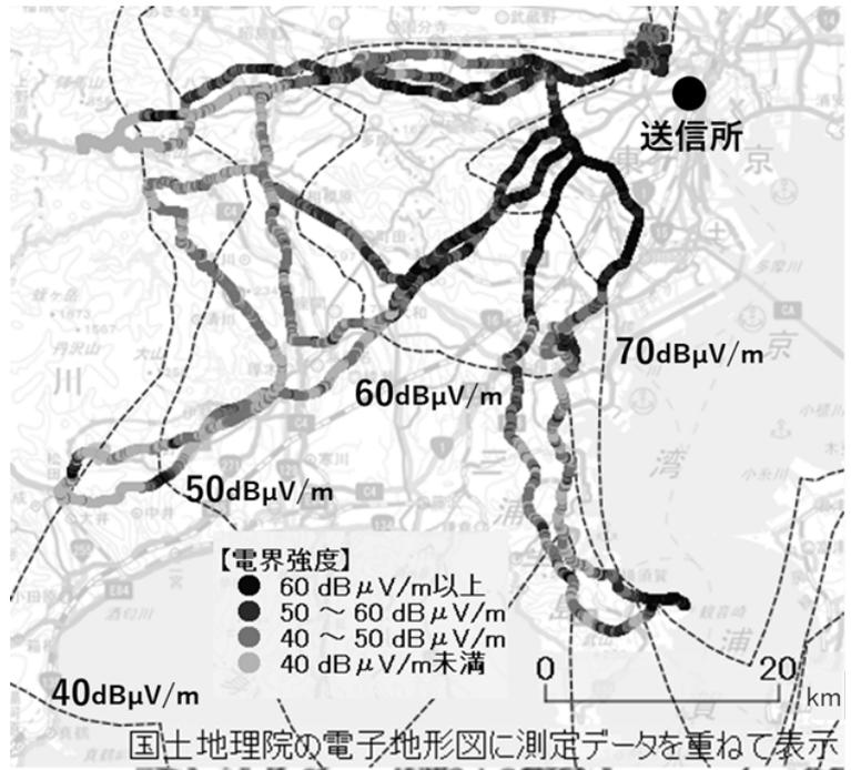
図 6-1 測定ルート上における電界強度
