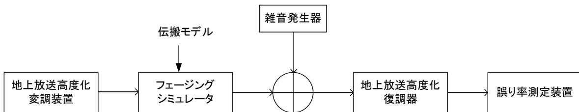
図 1-1 伝搬モデルを用いる場合の測定系
