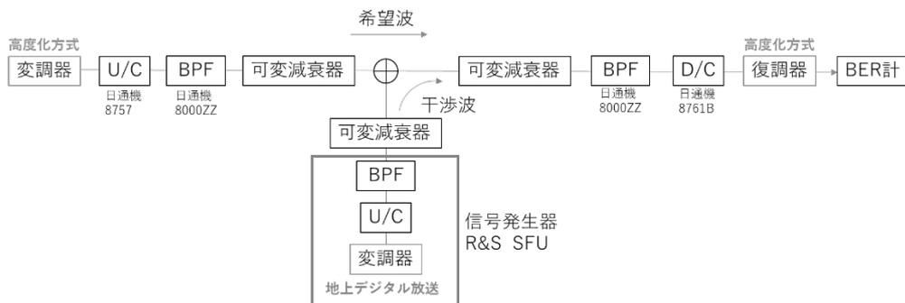
図 3-1 測定系統図
