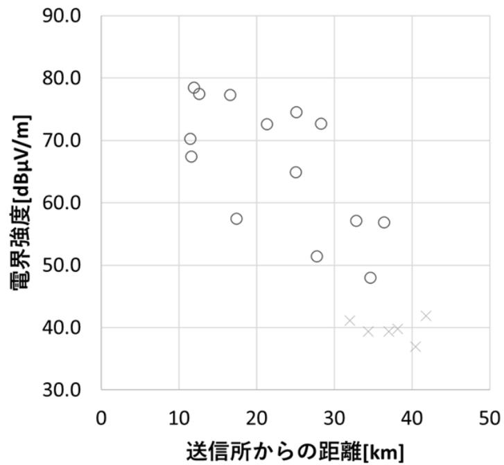
図 6-2 送信所からの距離・電界強度と受信可否の関係
