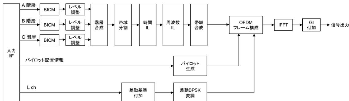
図 3.2.1.2.1-1 OFDM 変調部の構成
