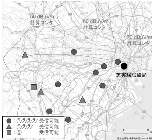
図 6-4 複数パラメータを用いた固定受信実験における受信可否の結果
