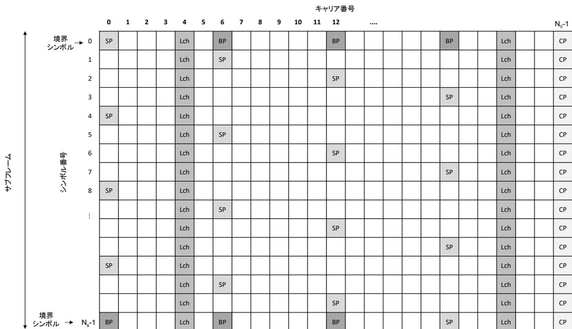
図 3.2.1.6.3.3.4-1 BP 配置の例 (Dx=6, Dy=4)
