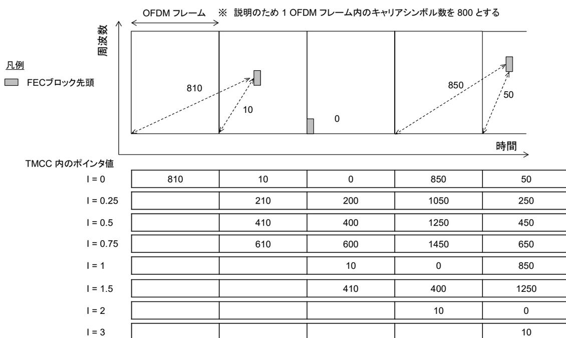
図 3.2.1.6.1.2.4-1 FEC ブロックポインタの遅延の例
