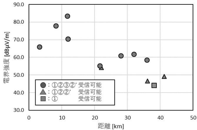
図 6-5 距離に対する電界強度
