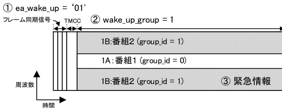
図 2-1 緊急起動制御の受信シーケンス（例）
