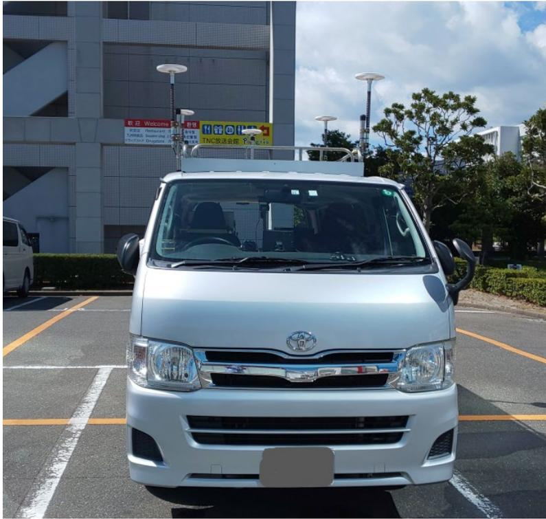
図 5.4-1 正面から見た測定車 屋根の上にアンテナ 5 基を設置
