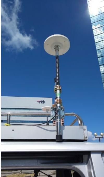
図 5.4-2 測定車の屋根に設置したアンテナ
