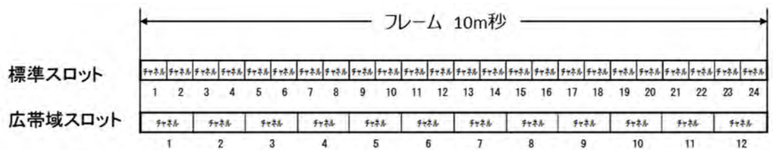
図4. 2-2 DECT方式のフレーム構成
