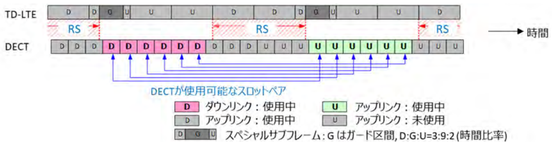
参図 3-6 TD-LTE 方式と DECT 方式の時間軸上の配置
