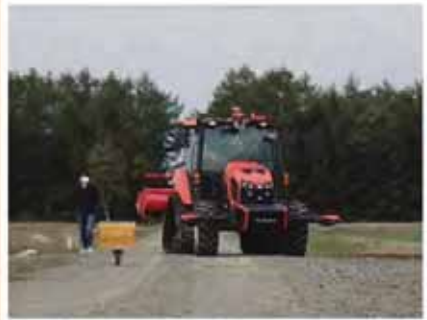
障害物を遠隔操縦で回避するロボットトラクター
