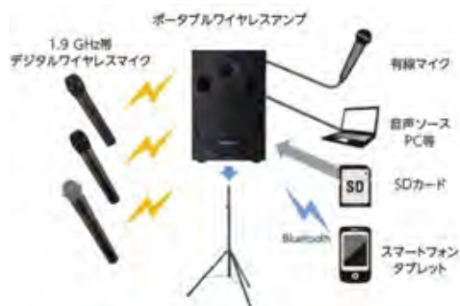
図2. 3-2 ポータブルワイヤレスアンプの製品例
