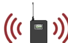
受信時や待ち受け時に無線機から漏れ出る電波のこと
