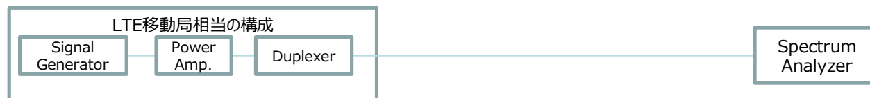
図：LTE移動局実力値の測定系（過去の検討時の測定系）
