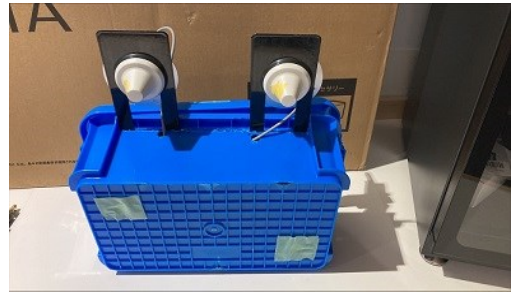
図 3.4-3 ドローンに搭載した機材ボックス
