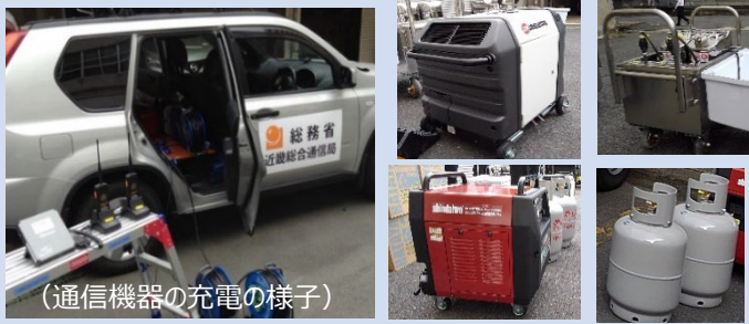
（通信機器の充電の様子） 移動電源車（車両に発電機を搭載、燃料ガソリン） 可搬型発電機（上段：燃料ガソリン、下段：燃料LPガス）
