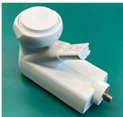
図2.1-5 ②B P F 追加による対策モデル 試作品
