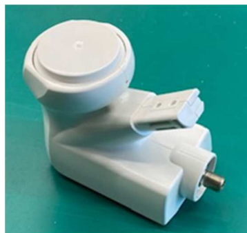
図2.1-6 ③一次放射器の円形導波管の設計変更による対策モデル 試作品
