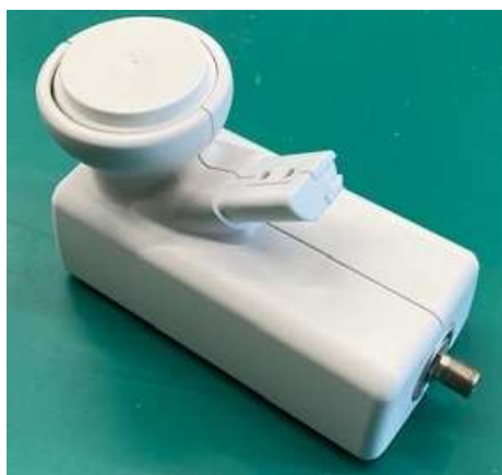
図 2.1-4 ①局発周波数をハイローカル (13.903GHz) による対策モデル 試作品
