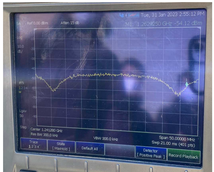
図 4.5-3 BS 受信画像良好時の受信画像とスペアナの観測波形例
