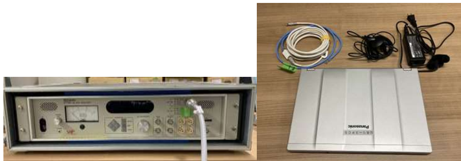
図 2-51 移動測定機材 (FM-SFN アナライザ (MODEL 5775A) ノート PC、LAN ケーブル、GPS レシーバ)
