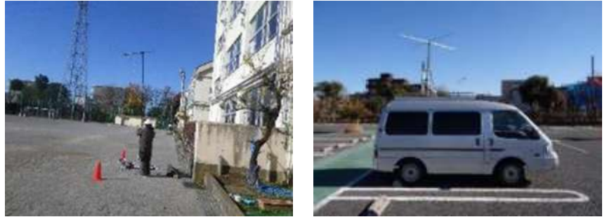
図2-10電波伝搬試験写真(左:定点測定、右:移動測定)
