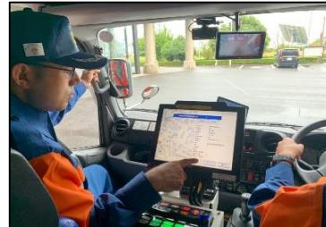
車両動態表示装置の導入
