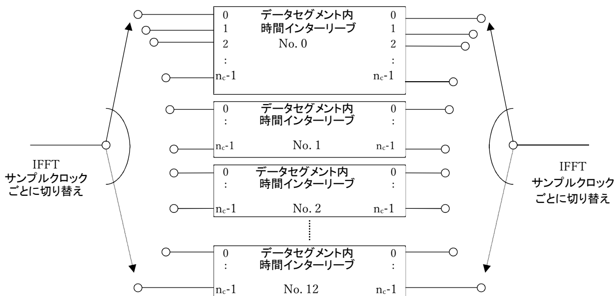
図 3. 2. 2. 3. 9-1 時間インターリーブの構成
