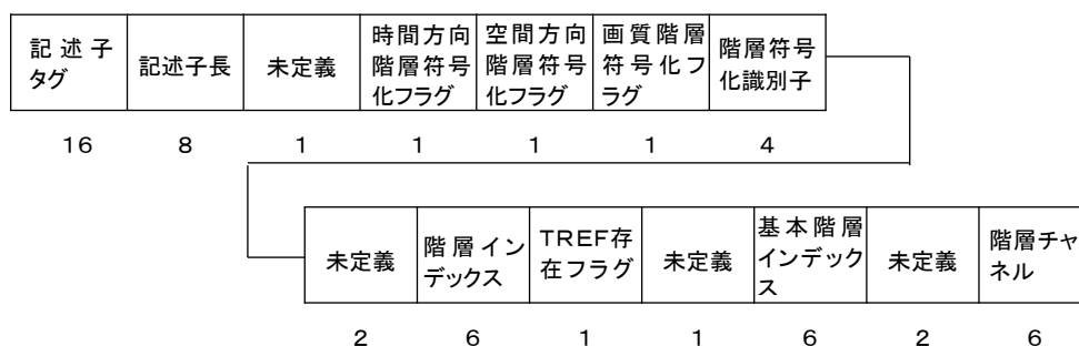
図 3.3.2.3-2 MH-階層符号化記述子の構成
