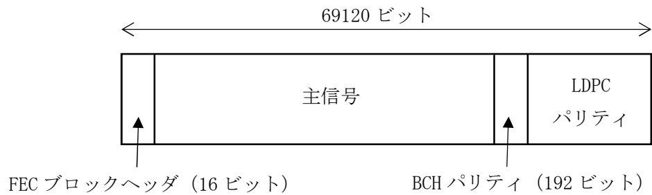
図 3.2.2.4.2.1-1 FEC ブロックの構成
