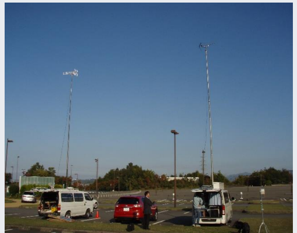
技術試験事務における潜在電界調査
