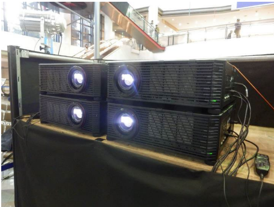
図 2-5 キヤノン製「4K600STZ」(光量 6000 ルーメン)を 4 台使用
