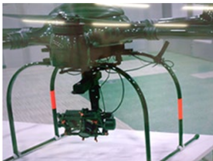
図 2.2.1-17 けいはんなロボット技術センターの設備 (8K カメラ搭載ドローン)
