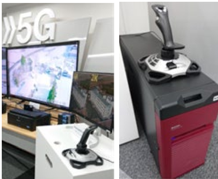
図 2.2.4-2 8K 映像切り出し装置 (広域 8K 映像より救助ポイント地点 映像を随時拡大表示)
