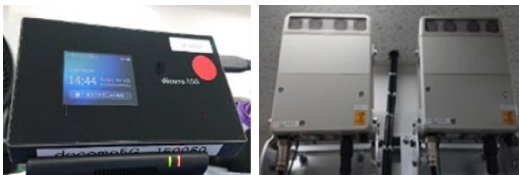
図 2.2.2-6 5G 送受信機（中継アンテナ）（左）・5G ルータ（右）
