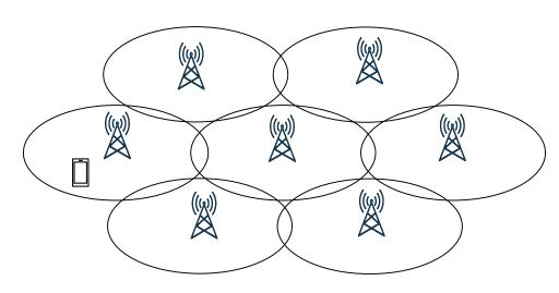
※ 基地局を稠密に開設することで、基地局と端末間の伝搬 ロスを低減。端末の送信電力を低く抑えることが可能
