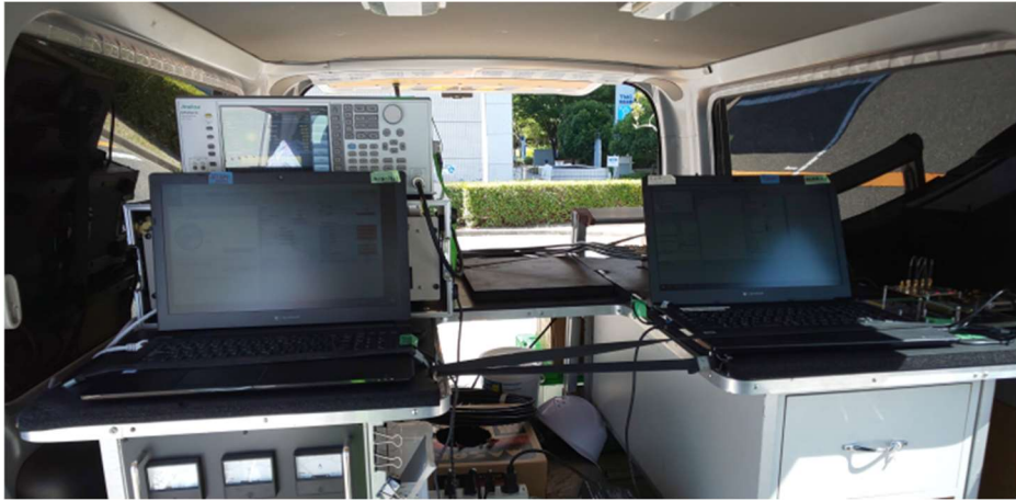
図 5.4-3 車内に設置した測定機器①
