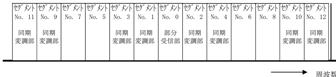
図 3.2.2.8-1 伝送スペクトル上の OFDM セグメント番号と使用例
