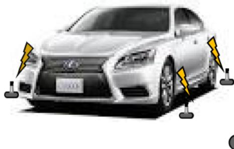
各タイヤに装着されたバルブセンサにて直接空気圧を測定し
