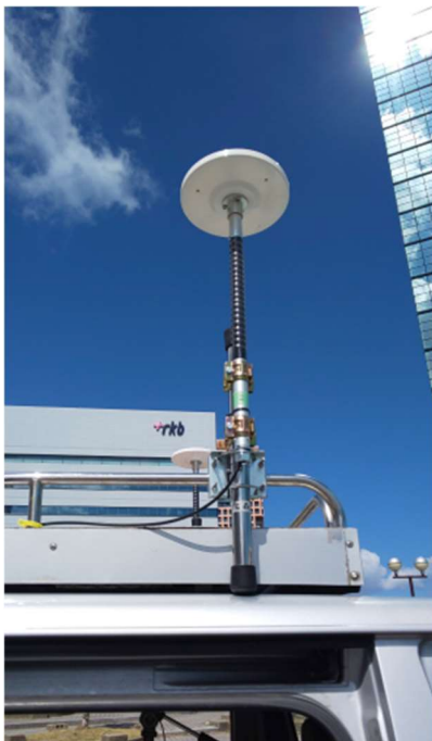
図 5. 4-2 測定車の屋根に設置したアンテナ (型名 : CL1039 無指向性)
