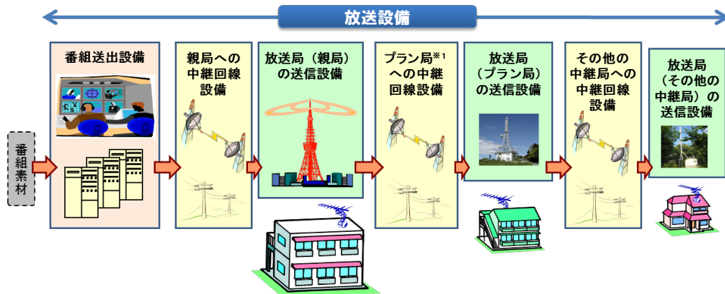
図2-2-1-1-1 地上デジタルテレビジョン放送に関する設備の構成例
