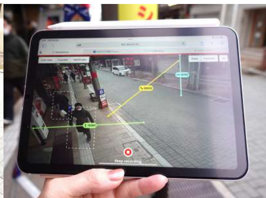
AIカメラによる計測画面 (映像は保存せず、計測結果のみ記録)
