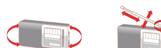
【AMラジオの場合】本体の向きを変える    【FMラジオの場合】アンテナの向きを変える
