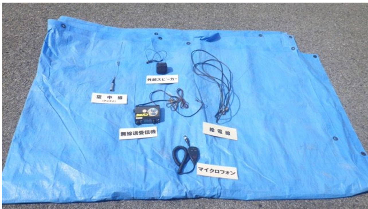
写真2：設置されていた無線設備
